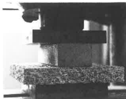
Figur 5. Trycktest av 30 mm platta.
