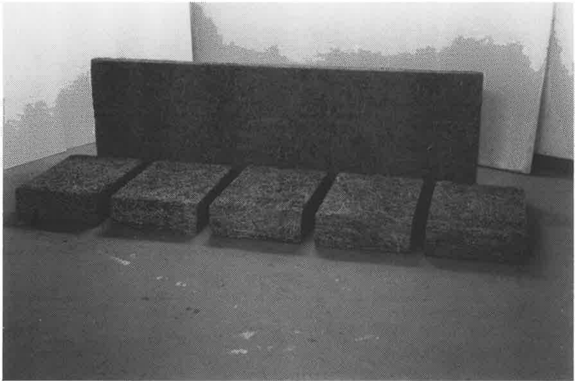
En 150 mm tjock standardplatta sågas upp till murblock.
